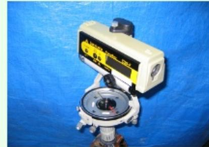
トラコンにレーザー測距器が搭載され
