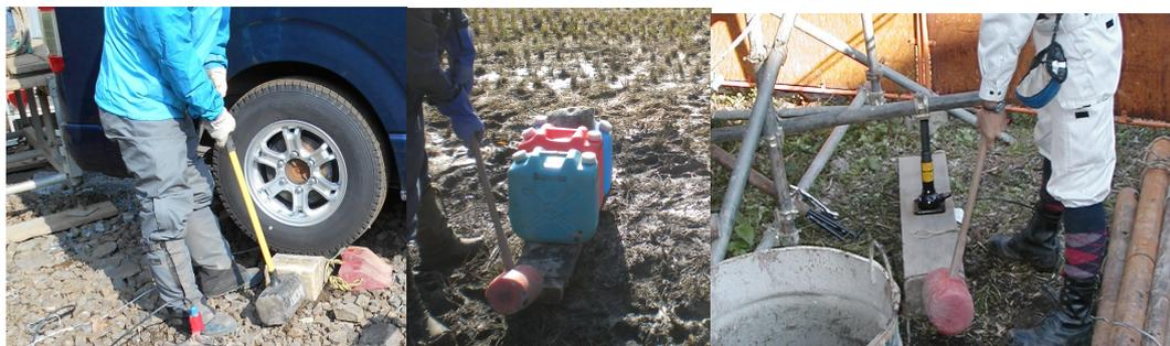
車載荷重 (深度 100mまで可)      ポリタン荷重 (深度 20mまで、人も載る)      ジャッキ荷重 (板とジャッキ間に免振ゴム)
